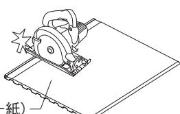
土台部や縦継ぎ部等で本体の端部をあらわしで納める際は、しん材の吸水を防ぐため、本体の下部からしん材を10mm程度取り除いてください。
