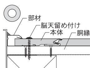
本体を切り欠き加工すると強度が低下して破損しやすくなります。本体を切り欠いて使用する場合は、本体がゆがまないように、切り欠いた部分に補強材（面材など）を当てて運搬してください。また、しん材や裏面材が破損した本体は使用しないでください。
